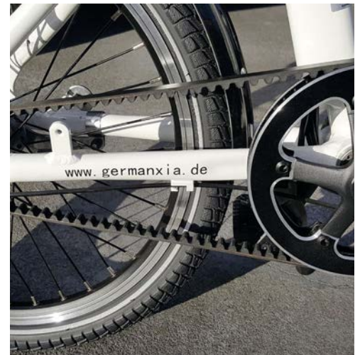
Bei diesem Modell wurde als eine Alternative die Kette durch einen Riemen ersetzt. Er ist leichter und leiser als eine Kette - und wartungsfrei.
