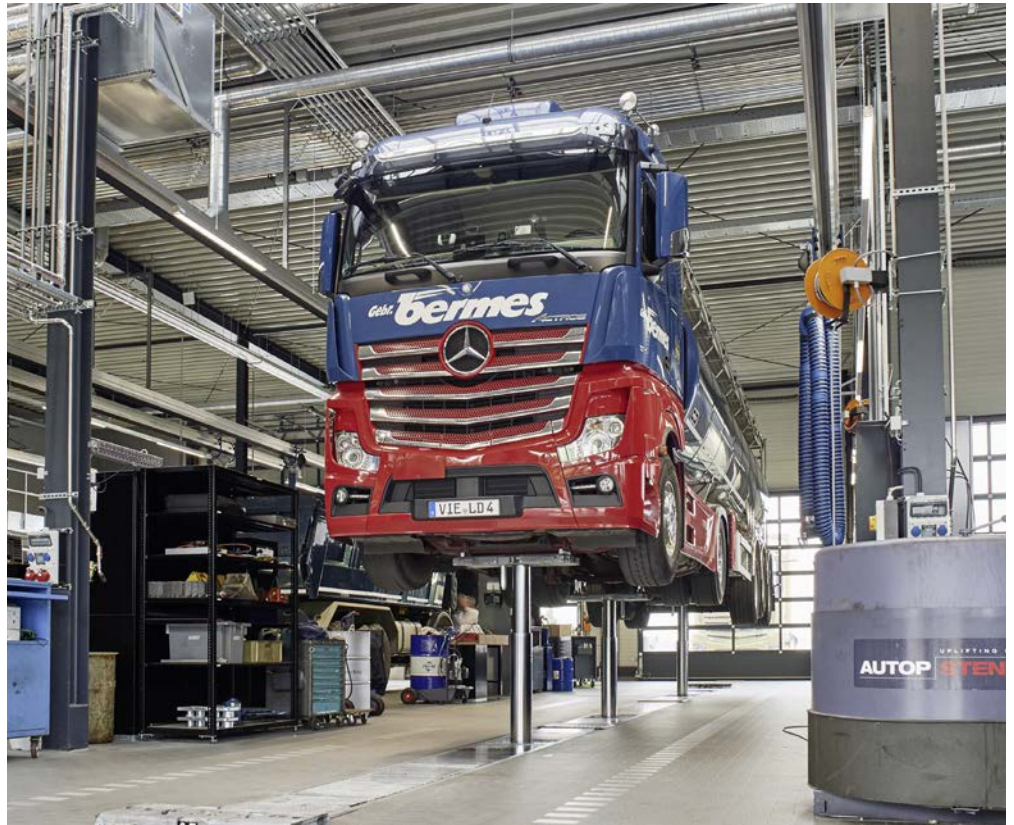
Lkw-Werkstatt mit Stempelhebebühne für komplett beladene Sattelzüge bis 95 Tonnen.
